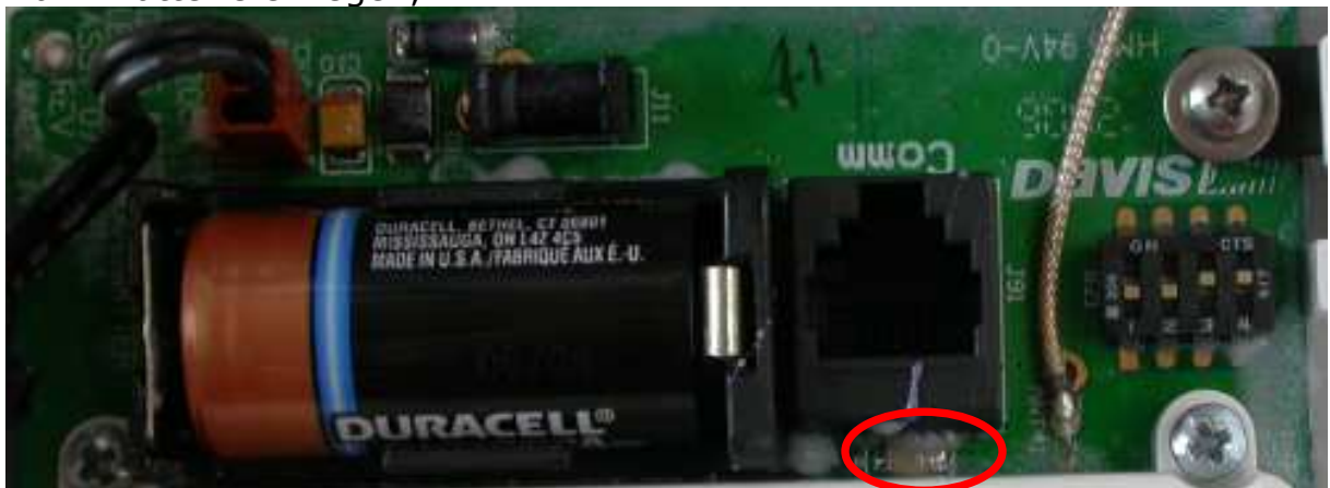
Kontrolllampe mitte flasht, wenn die Batterie voll ist
