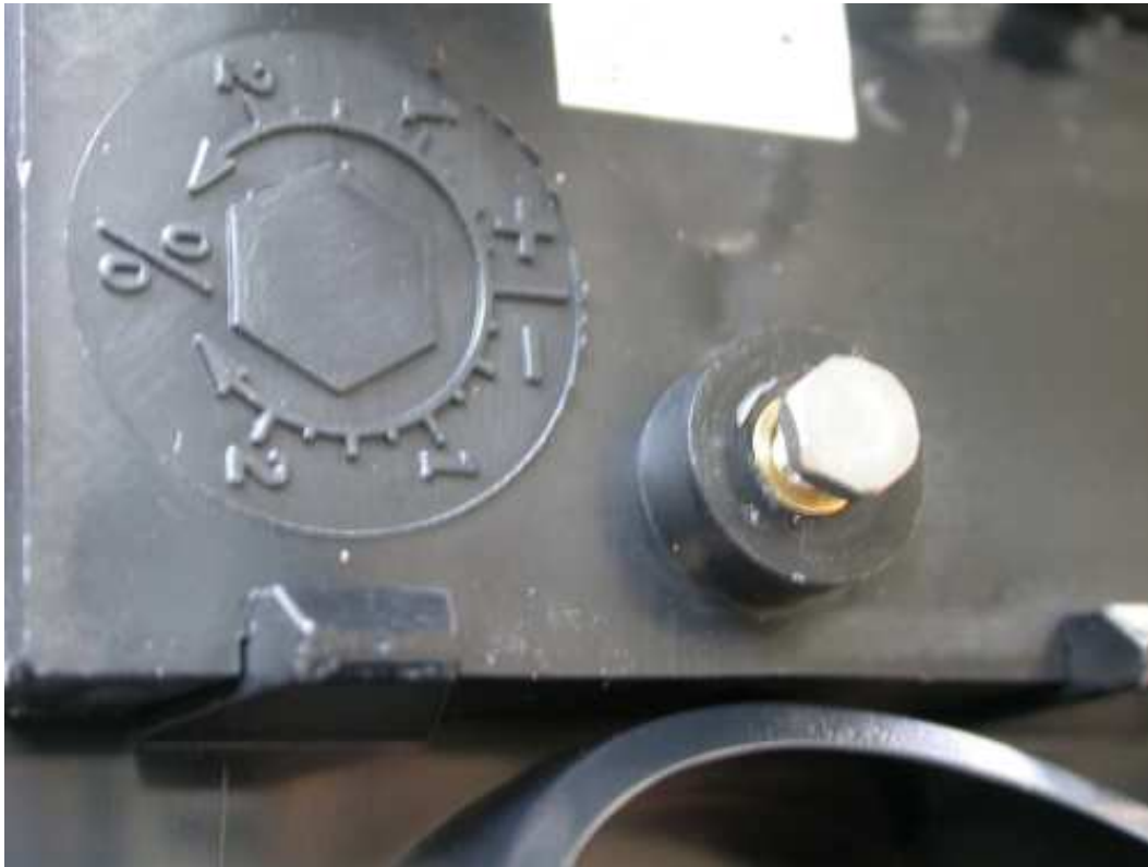
Regulierungsschrauben zur Eichung des Regenmessers. (Optional: Der Regenmesse muss bei 4,2ml Wasser kippen.)
