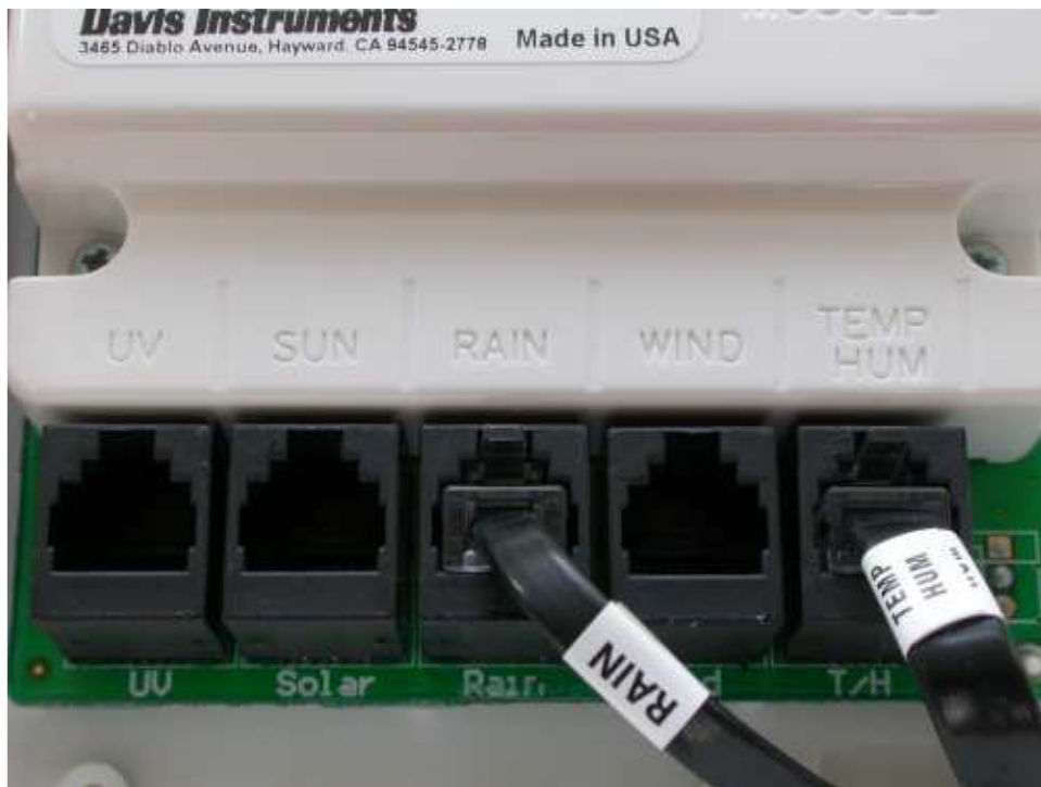
Windsensor in die ISS einstecken
