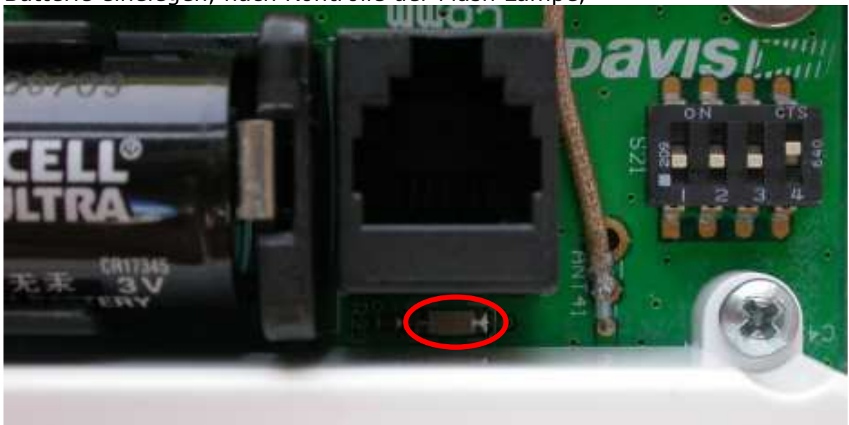
Dipschalter der Sendeeinheit ISS Schalter 4 auf Test stellen und Batterie einlegen, nach Kontrolle der Flash Lampe,
